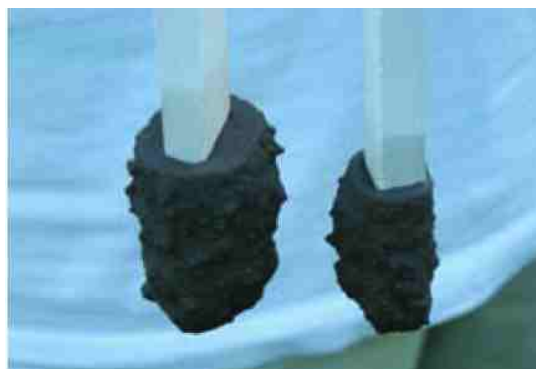
DERMESZTETT BETON KÉT KÜLÖNBÖZŐ PÓRUSSZERKEZETŰ GIPSZ PÁLCÁN
